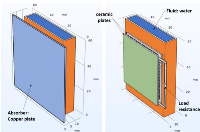
Fig. 3. Structure du module TEG proposer
