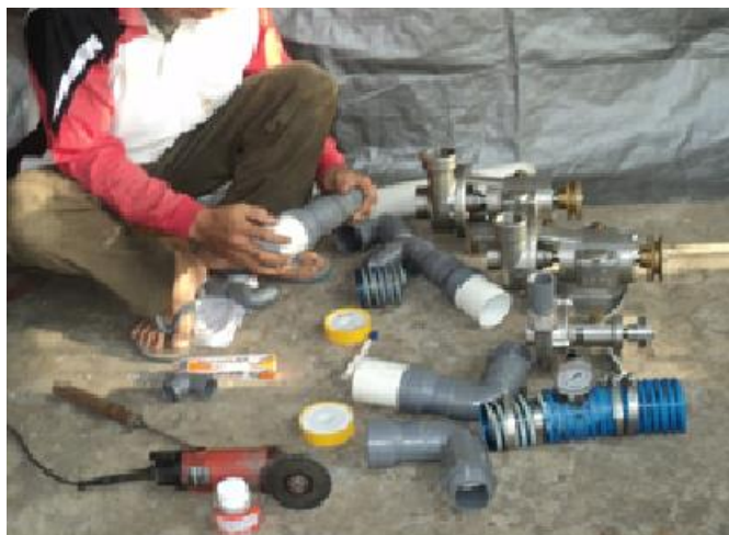
Fig. 4. Pump-as-turbine modification process
